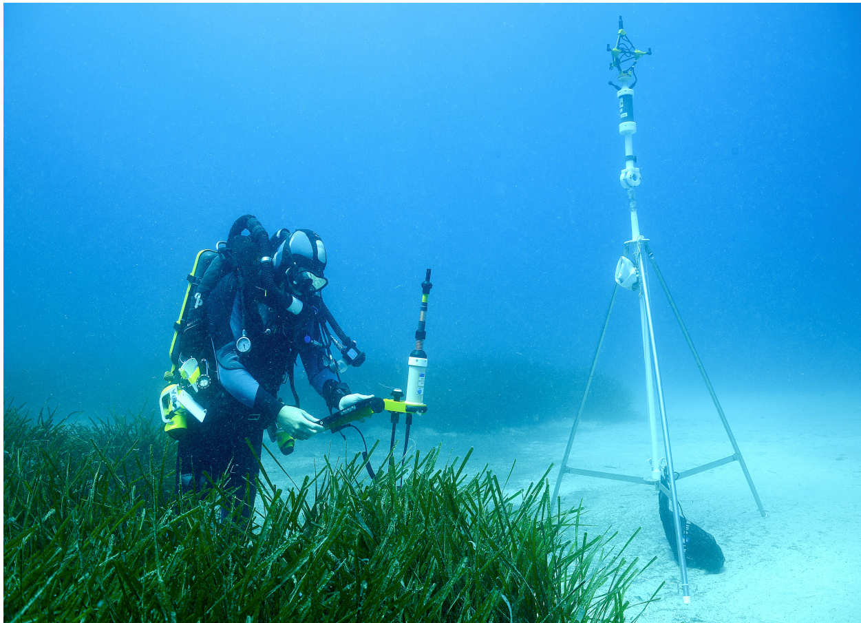
MiniPointer R300-NG with watertight Android tablet «AllTab 2.0» (photo © Andromède Océanologie)
